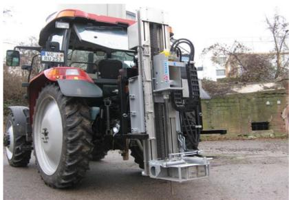
Abb. 3: Bodenprobennehmer
